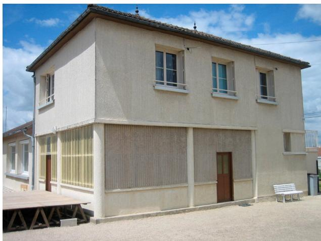
L'objectif était de transformer ce lieu en salle multi-usages. Les vieilles tôles fixes en PVC ont été remplacées par des fenêtres aluminium ouvrantes, le sol en enrobé a été remplacé par du carrelage et les murs refaits en béton cellulaire isolant. Un plafond suspendu a
