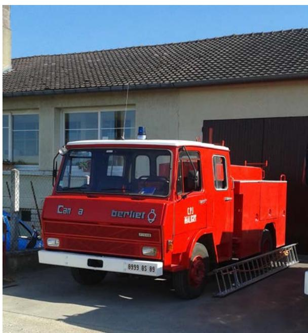
Leur camion fourgon pompe tonne donne des signes d'usure inquiétants. La citerne fuit et n'est plus réparable. Le dernier passage aux mines a été refusé en raison d'un déséquilibre des freins. Cerise sur le gâteau, à leur dernière intervention le moteur s'est mis à fumer et a rendu le véhicule inutilisable.
